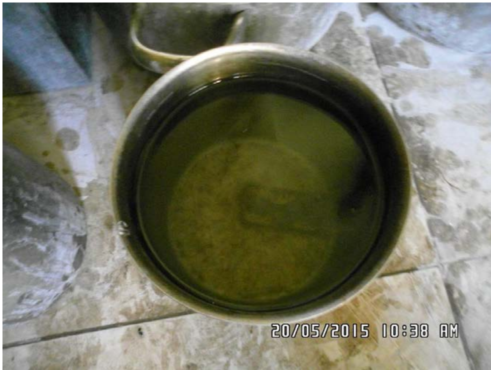
Рисунок 11: Слиток во время охлаждения в ведре с водой
