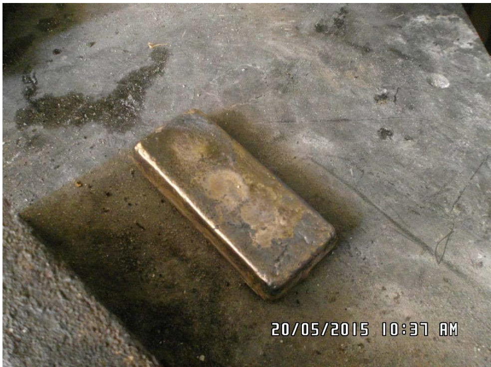
Рисунок 10: Готовый слиток, извлеченный из формы. Судя по цвету, его пробность составляет около 800
