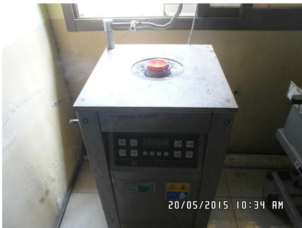
Рисунок 6: Плавильная печь, используемая для переплавки слитков, импортирована из Швейцарии
