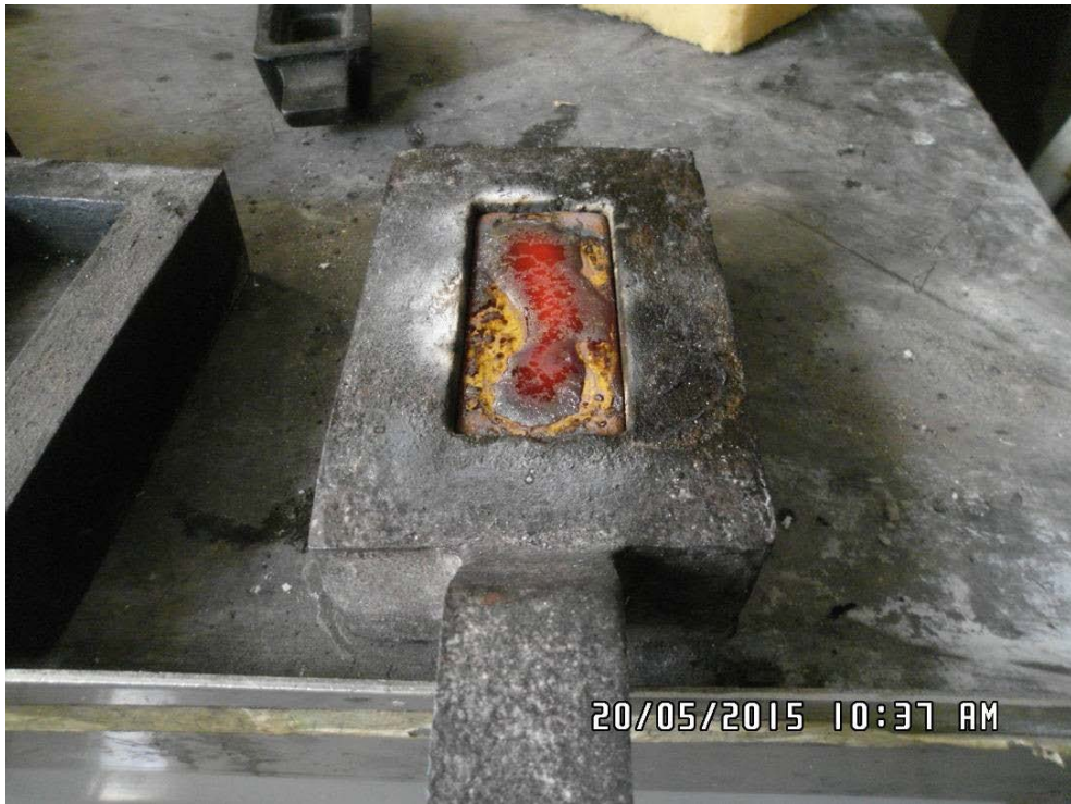
Рисунок 9: Готовый слиток. При охлаждении можно видеть, что бура удалила примеси из исходного сплава Доре
