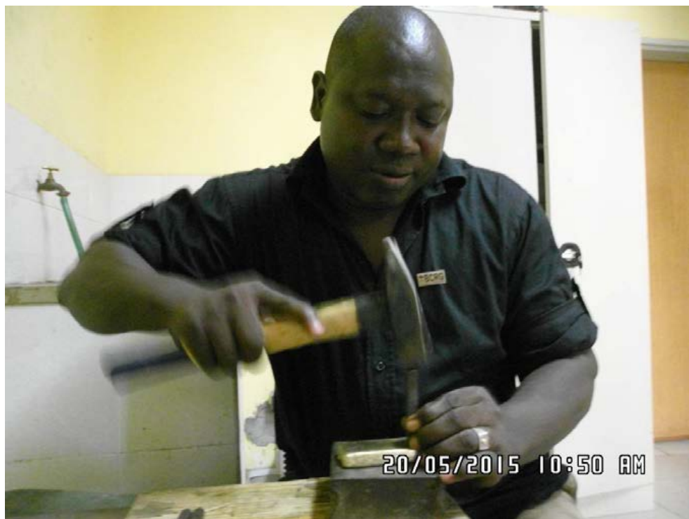
Рисунок 16: Штамповка клейма и маркировка слитка печатью Центрального банка Гвинеи. На слитке Доре не указывается какая-либо информация об исходном производителе
